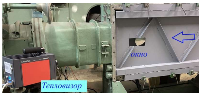
Рис. 18. Рабочая часть аэродинамической установки с исследуемыми цилиндрами. Схема (а) и фотографии рабочего канала (б) с открытой боковой стенкой (слева) и с закрытой боковой стенкой с окном для наблюдения тепловизором (справа). Направление потока указано стрелкой
