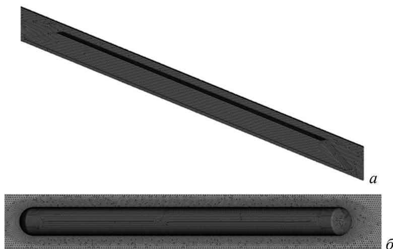
Рис. 1. Варианты упрощенной формы капсулы Hyperloop: *а*) с плоской наклонной головной частью; *б*) с затупленной сферической головной частью (по материалам работы [13])
