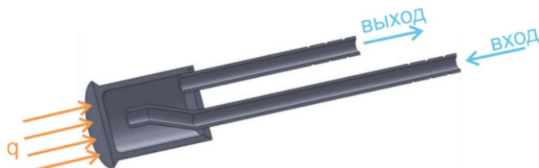
Рис. 2. Схема калориметрического датчика
