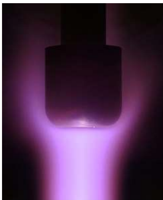
Рис. 1. Обтекание модели в струе плазмотрона ВГУ-4
