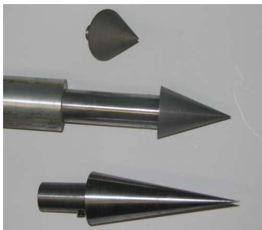
Рис. 4. Экспериментальная модель со сменными наконечниками
