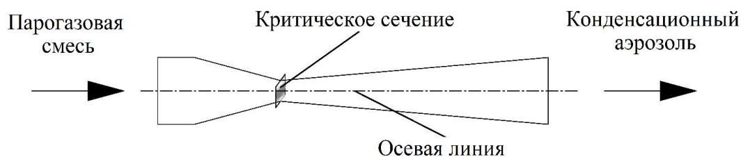
Рис. 1. Схема течения парогазовой смеси в щелевом сопле Лавала
