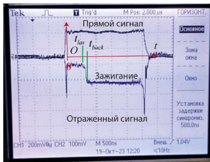
Рис. 3. Пример показаний осциллографа при измерении сигналов прямого и отраженного излучения СВЧ в волноводе, импульс лазера подан к 0.5 мкс
