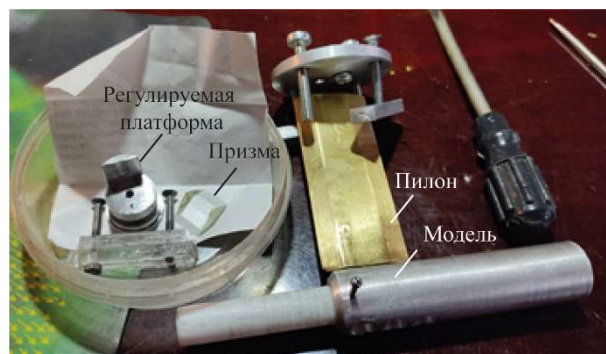
Рис. 2. Разобранная система для размещения призмы в сверхзвуковом потоке: модель с пластиковой полкой вставкой ( \varnothing 12 мм), обтекаемый пилон, регулировочная платформа призмы в торце оболочки, призма
