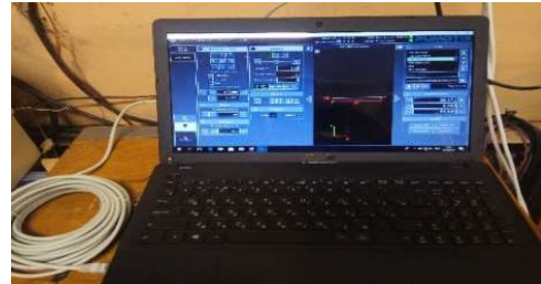
Рис. 7. Блок-схема автоматизированной системы управления движением электродов (а) и фото некоторых её модулей: линейный привод (б) и шкаф с устройствами его управления (в), ПК с ПО PUMOTIX в ЧПУ-системе Purelogic (г)
