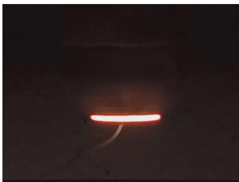
Рис. 10. Трек частицы углерода у поверхности образца графита МПГ-7, нагретого лазерным излучением
