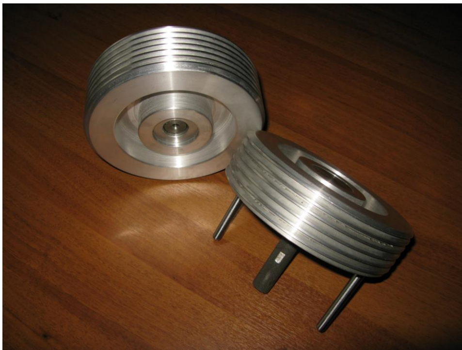
Рис. 6. Спроектированные и изготовленные проходной и непроходной калибры
