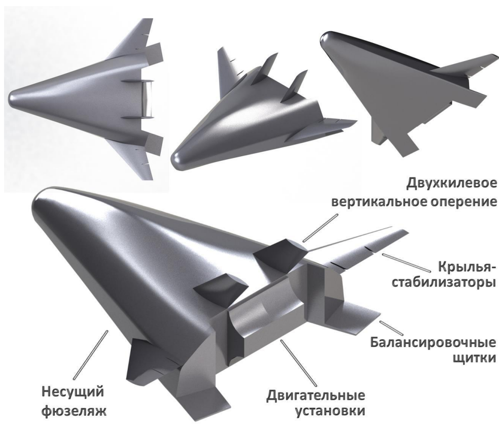
Рис. 6. Виды разработанной виртуальной поверхности летательного аппарата X-33
