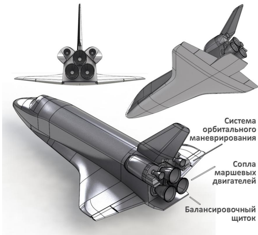
Рис.10. Различные ракурсы хвостовой части виртуальной модели орбитального ракетоплана Space Shuttle
