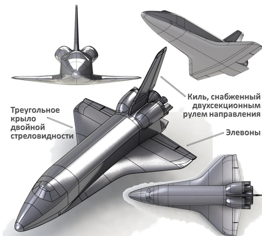
Рис.9. Вид носовой части созданной компьютерной поверхности воздушно-космического самолета Space Shuttle
