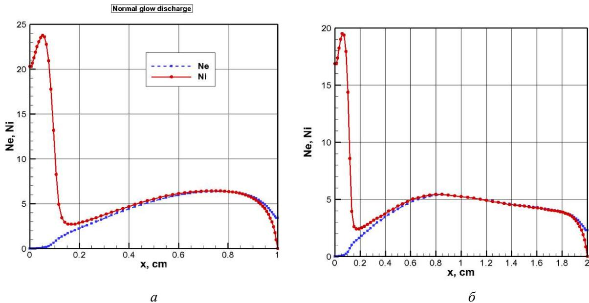
Рис. 5. Распределение концентраций ионов и электронов вдоль оси симметрии нормального тлеющего разряда,  $\varepsilon = 1000$  В,  $R_0 = 300$  к $\Omega$ ,  $p = 5$  Торр при  $H = 1$  см (а) и 2 см (б)
