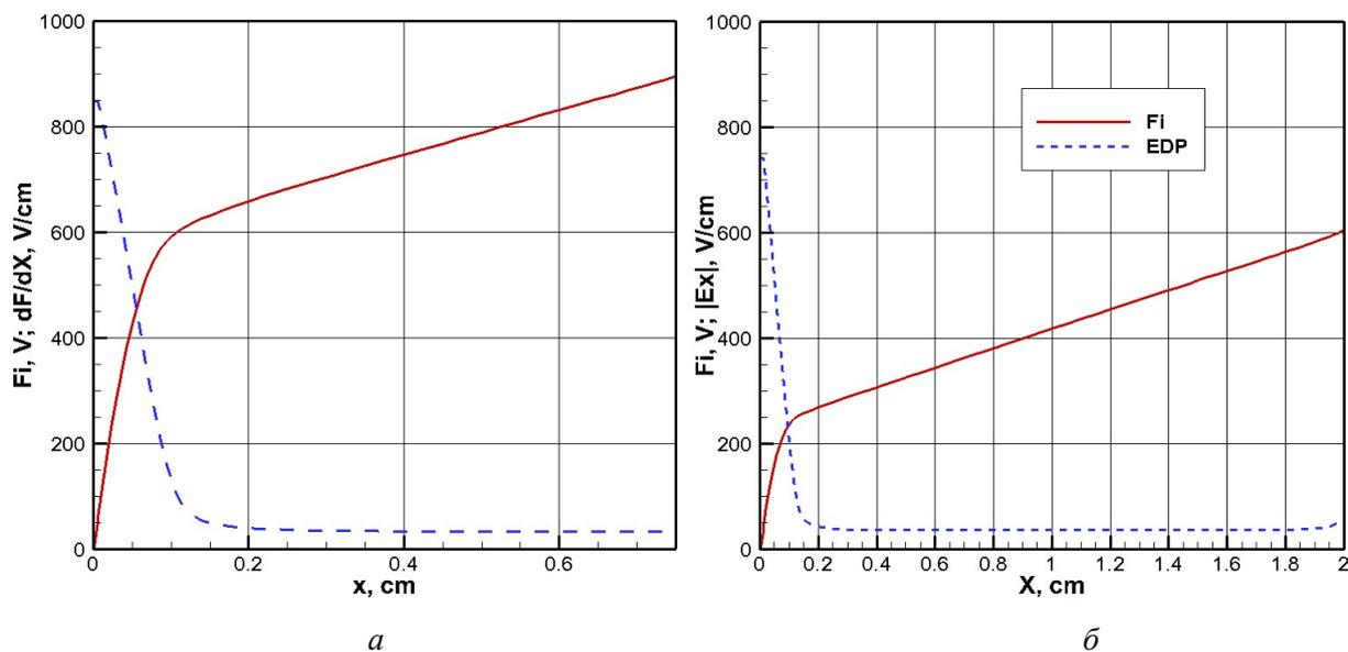
Рис. 6. Распределение электрического потенциала и модуля осевой составляющей электрического поля вдоль оси симметрии нормальных тлеющих разрядов в газоразрядном промежутке высотой  $H = 1$  см (а) и 2 см (б)
