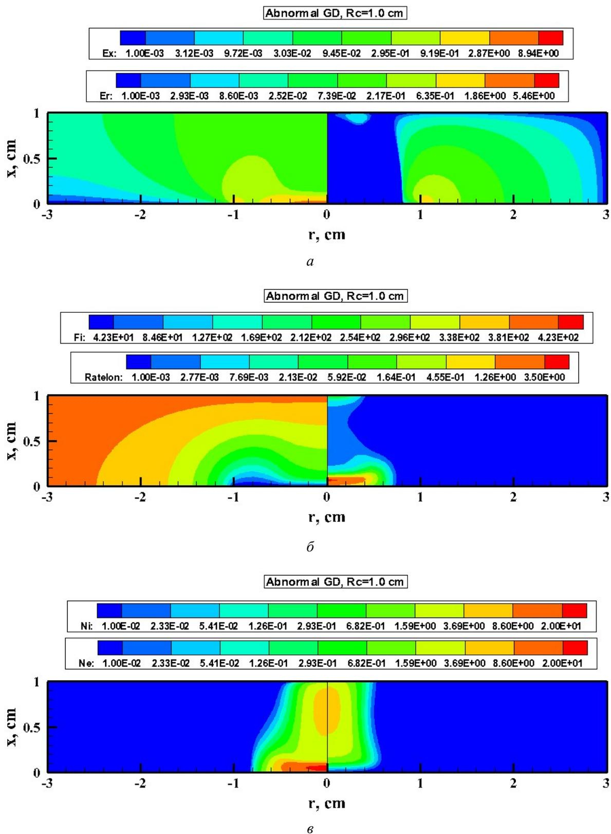
Рис. 8. Распределения нормальной (слева) и радиальной (справа) компонент электрического поля (*a*), электрического потенциала (слева) и скорости ионизации (справа) (*b*), концентраций ионов (слева) и электронов (справа) (*v*) в нормальном тлеющем разряде,  $\varepsilon=1000$  В,  $R_0=300$  к $\Omega$ ,  $p=5$  Торр. Радиус катодной секции  $R_c=1.0$  см
