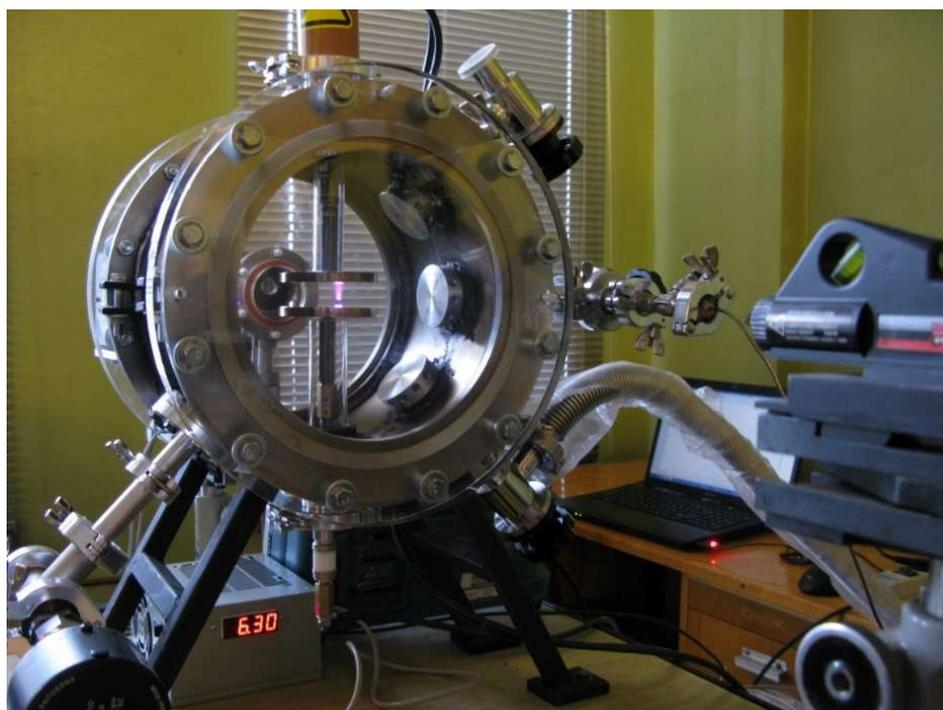
Рис. 2. Нормальный тлеющий разряд в физическом эксперименте [2]
