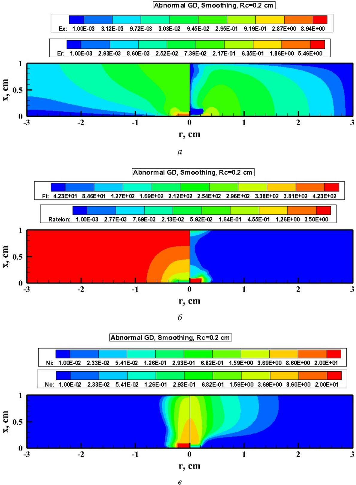
Рис. 15. Распределения нормальной (слева) и радиальной (справа) компонент электрического поля (*a*), электрического потенциала (слева) и скорости ионизации (справа) (*b*), концентраций ионов (слева) и электронов (справа) (*v*) в нормальном тлеющем разряде,  $\varepsilon = 1000$  В,  $R_0 = 300$  к $\Omega$ ,  $p = 5$  Торр. Радиус катодной секции  $R_c = 0.2$  см. Сглаживание напряженности электрического поля вблизи катода
