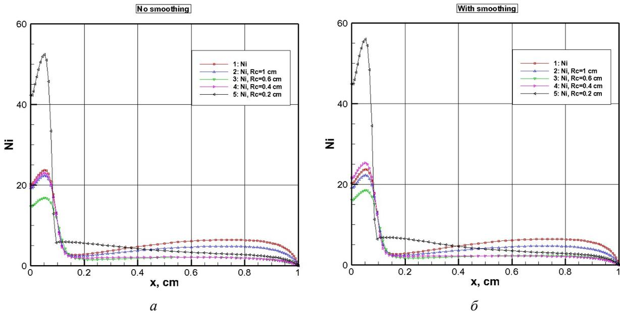
Рис. 25. Распределение концентраций ионов вдоль оси симметрии нормального и аномального тлеющего разряда без сглаживания (*a*) и со сглаживанием (*б*) распределения электрического потенциала вблизи катода,  $\varepsilon = 1000$  В,  $R_0 = 300$  к $\Omega$ ,  $p = 5$  Торр
