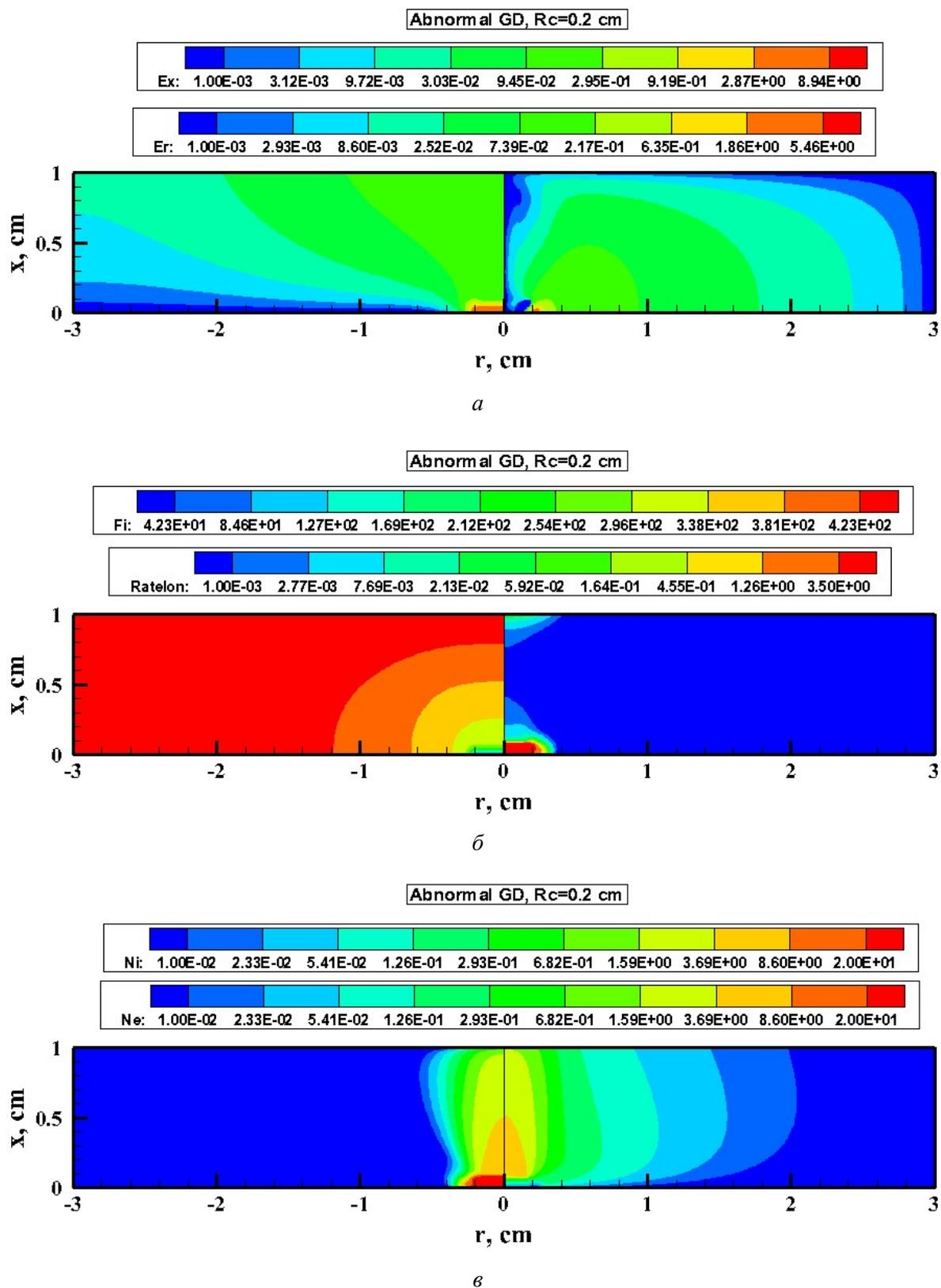
Рис. 14. Распределения нормальной (слева) и радиальной (справа) компонент электрического поля ( $a$ ), электрического потенциала (слева) и скорости ионизации (справа) ( $\bar{b}$ ), концентраций ионов (слева) и электронов (справа) ( $\bar{c}$ ) в нормальном тлеющем разряде,  $\varepsilon = 1000$  В,  $R_0 = 300$  к $\Omega$ ,  $p = 5$  Торр. Радиус катодной секции  $R_c = 0.2$  см
