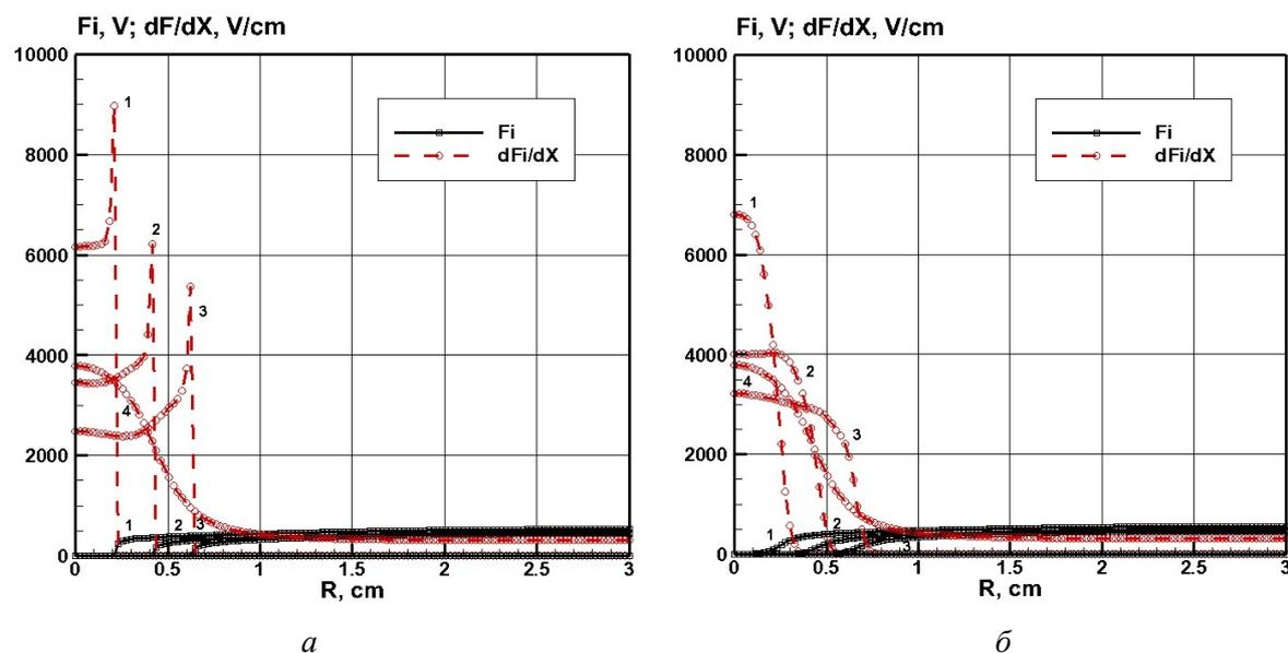
Рис. 27. Распределения напряженности электрического поля и электрического потенциала вдоль поверхности катода без использования сглаживания (а) и со сглаживанием (б) электрического поля вблизи поверхности катода,  $\varepsilon = 1000$  В,  $R_0 = 300$  к $\Omega$ ,  $p = 5$  Торр.  $H = 2$  см
