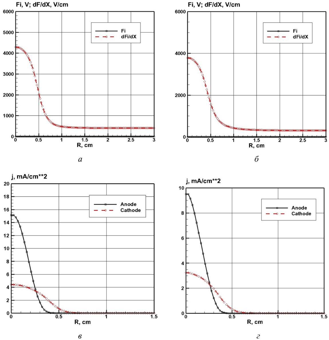
Рис. 7. Распределение электрического потенциала и модуля осевой составляющей электрического поля ( $a, б$ ), а также плотностей тока на катоде и аноде вдоль радиуса катода ( $в, г$ ) нормальных тлеющих разрядов в газоразрядном промежутке высотой  $H=1$  и  $2$  см
