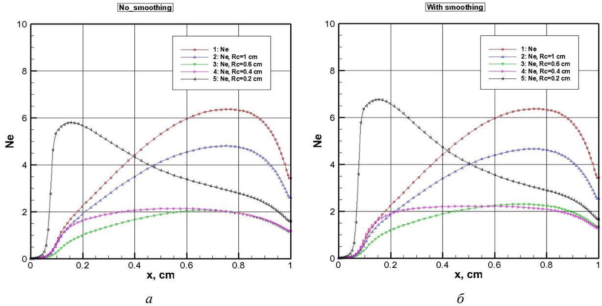
Рис. 24. Распределение электронных концентраций вдоль оси симметрии нормального и аномального тлеющего разряда без сглаживания (*a*) и со сглаживанием (*б*) распределения электрического потенциала вблизи катода,  $\varepsilon = 1000$  В,  $R_0 = 300$  к $\Omega$ ,  $p = 5$  Торр
