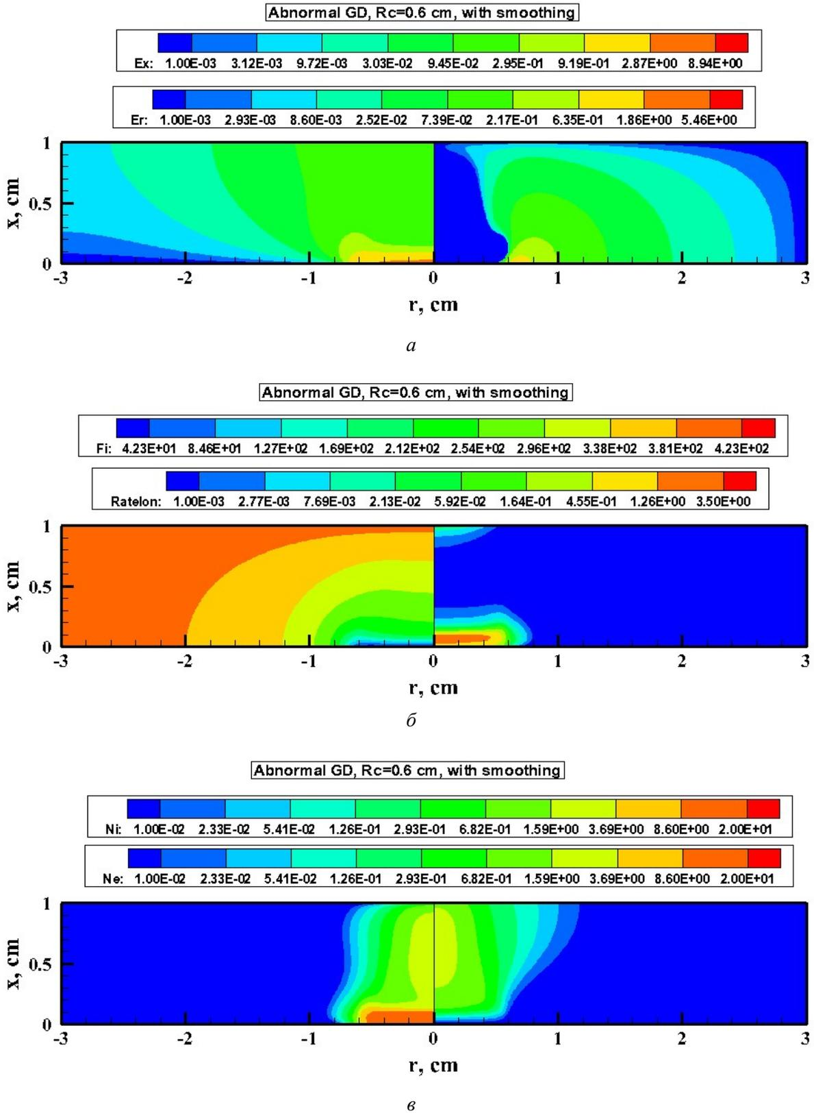
Рис. 11. Распределения нормальной (слева) и радиальной (справа) компонент электрического поля ( $a$ ), электрического потенциала (слева) и скорости ионизации (справа) ( $b$ ), концентраций ионов (слева) и электронов (справа) ( $c$ ) в нормальном тлеющем разряде,  $\varepsilon=1000$  В,  $R_0=300$  к $\Omega$ ,  $p=5$  Торр. Радиус катодной секции  $R_c=0.6$  см. Сглаживание напряженности электрического поля вблизи катода
