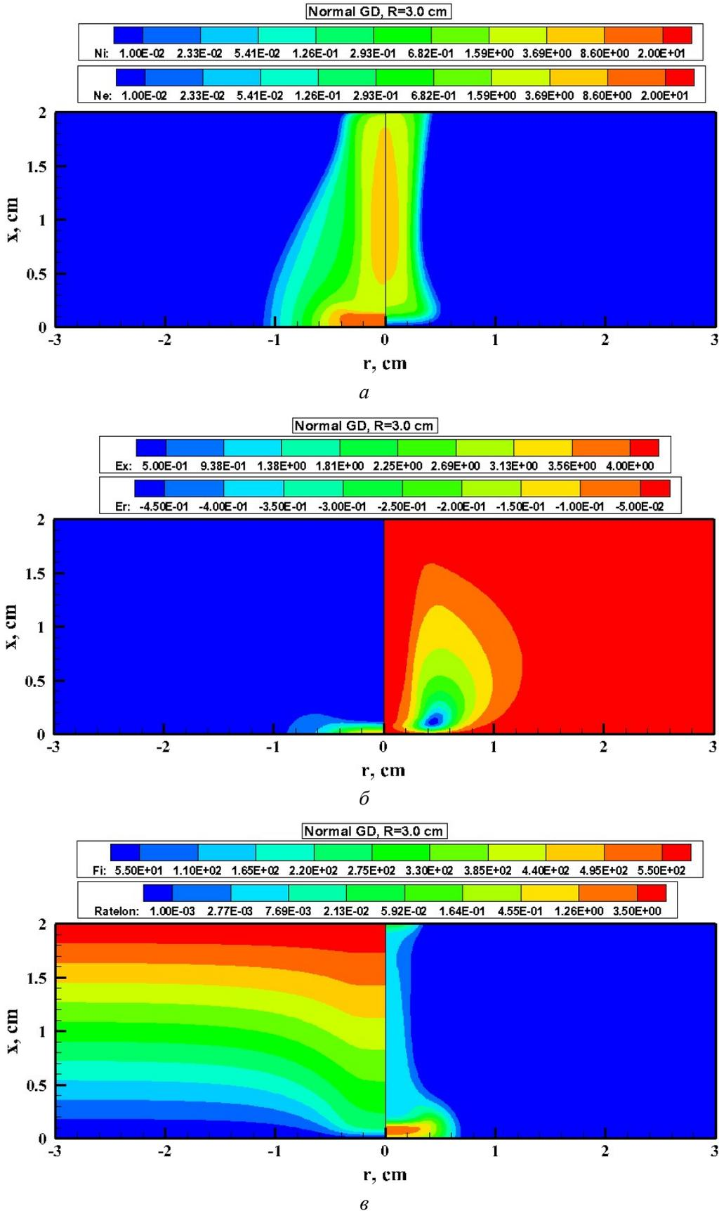
Рис. 4. Распределения нормальной (слева) и радиальной (справа) компонент электрического поля (а), электрического потенциала (слева) и скорости ионизации (справа) (б), концентраций ионов (слева) и электронов (справа) (в) в нормальном тлеющем разряде в электроразрядном промежутке высотой  $H=2$  см и радиусом  $R_c=3$  см;  $\varepsilon=1000$  В,  $R_0=300$  к $\Omega$ ,  $p=5$  Торр
