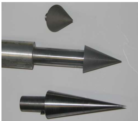
Рис. 2. Экспериментальная модель со сменными наконечниками
