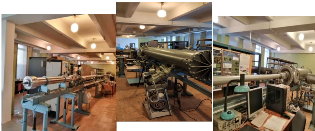
Рис. 1. Виды ГУАТ со стороны ударной трубы и ресивера
