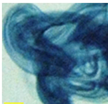
Рис. 6. Эволюция распределения вещества составной капли на позднем этапе слияния составной капли в импактном режиме. Длина маркера – 1 мм
