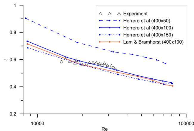
Рис.3. Зависимость рассчитанного коэффициента сопротивления от размерности сетки и сравнение с экспериментальными данными для  $\sigma = 1.1$
