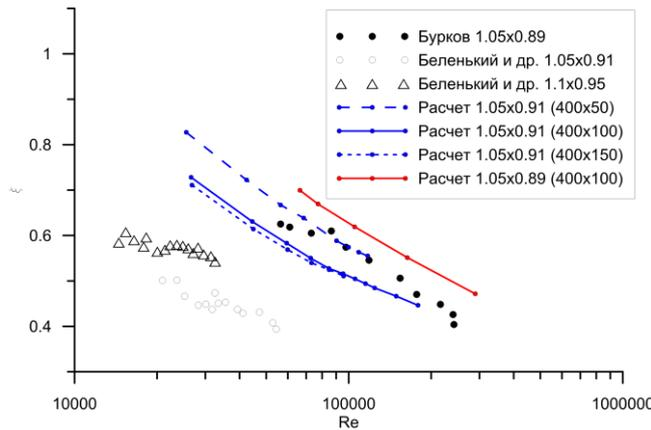
Рис. 7. Зависимость рассчитанного коэффициента сопротивления от размерности сетки и сравнение с экспериментальными данными для  $\sigma = 1.05$
