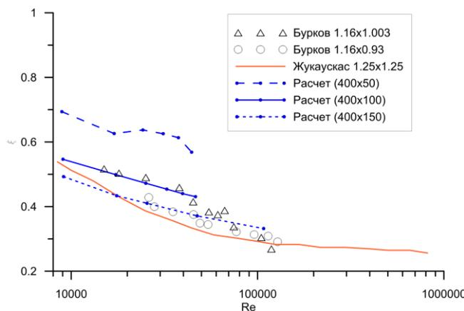
Рис. 8. Зависимость рассчитанного коэффициента сопротивления от размерности сетки и сравнение с экспериментальными данными для  $\sigma = 1.25$
