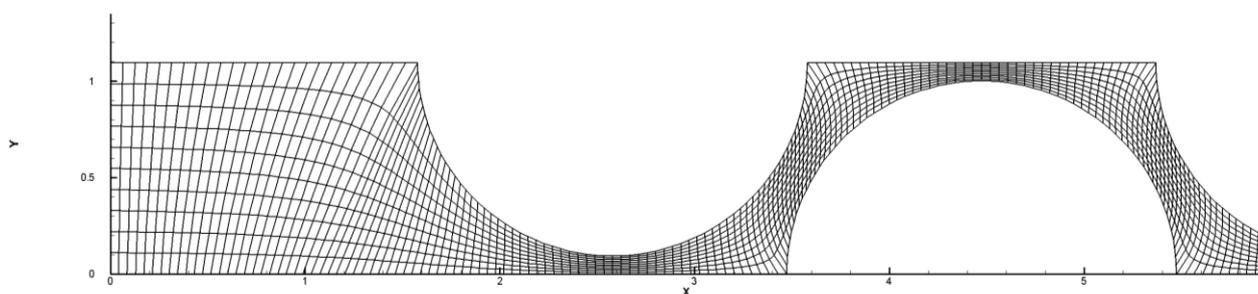
Рис.2. Увеличенный начальный участок расчетной сетки  $400 \times 10$  ячеек
