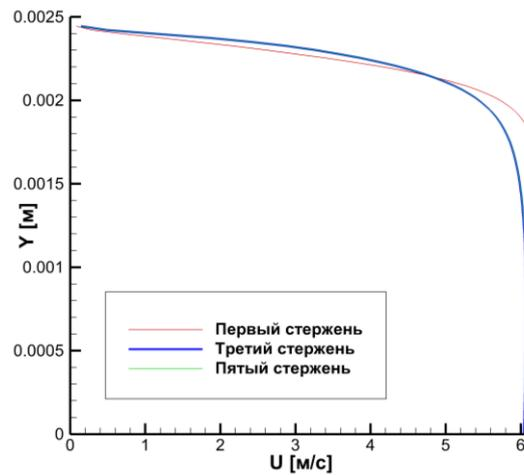
Рис.5. Распределение продольной скорости в точках сужения пучка труб, соответствующих положению первого, третьего и пятого стержней при  $\Delta p = 0.0025$  атм и  $\sigma = 1.1$
