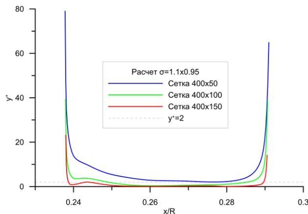
Рис. 6. Распределения  $y^+$  в центрах ближайших к границе ячеек вдоль пятого стержня при  $\Delta p = 0.0025$  атм и  $\sigma = 1.1$
