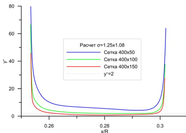
Рис. 9. Распределения  $y^+$  в центрах ближайших к границе ячеек вдоль пятого стержня при  $\Delta p = 0.0025$  атм и  $\sigma = 1.25$
