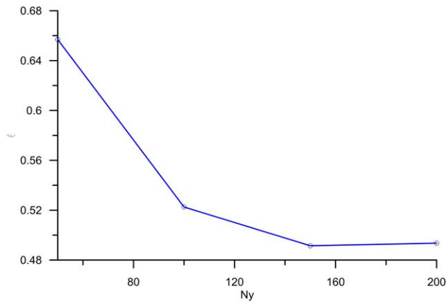
Рис. 4. Значения коэффициента гидравлического сопротивления в зависимости от числа ячеек в поперечном направлении при  $\Delta p = 0.0025$  атм и  $\sigma = 1.1$
