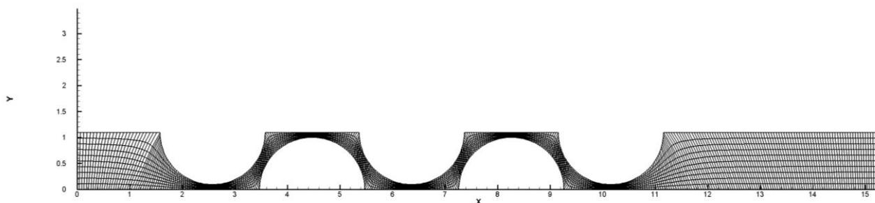
Рис.1. Расчетная область и расчетная сетка  $400 \times 10$  ячеек
