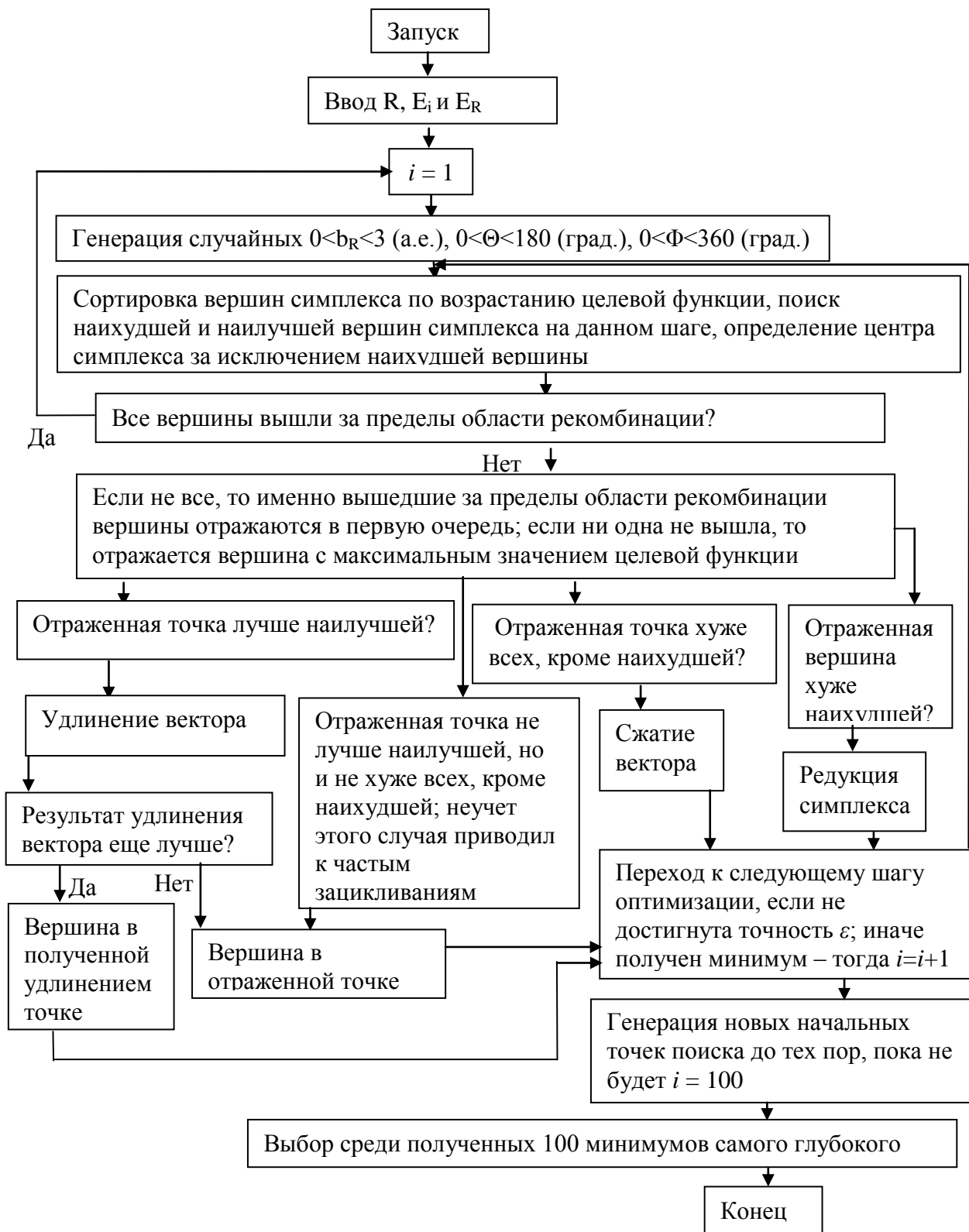
Рис.1b. Блок-схема метода деформируемого многогранника для определения значений начальных кинематических параметров, приводящих к максимальной стабилизации молекулы CsBr, с выбором начальных точек поиска по всей области определения параметров b_R , \Theta , \Phi
