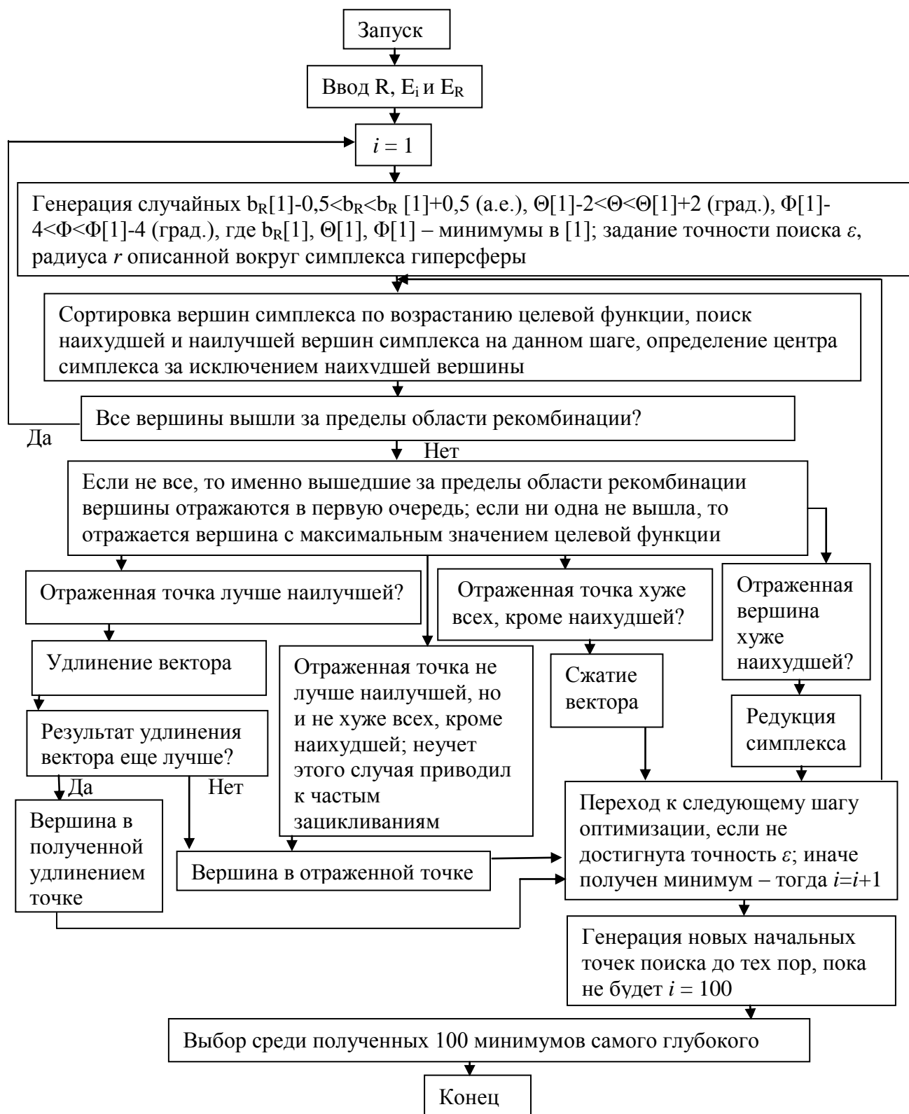
Рис.1а. Блок-схема метода деформируемого многогранника для определения значений начальных кинематических параметров, приводящих к максимальной стабилизации молекулы CsBr, с выбором начальных точек поиска вблизи получаемых минимумов
