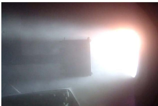
Рис.4. Струя аргоновой плазмы с углеродным порошком
