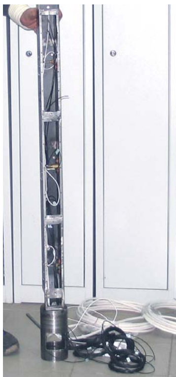
Рис. 7. Измерительная планка с установленными внутри ее датчиками
