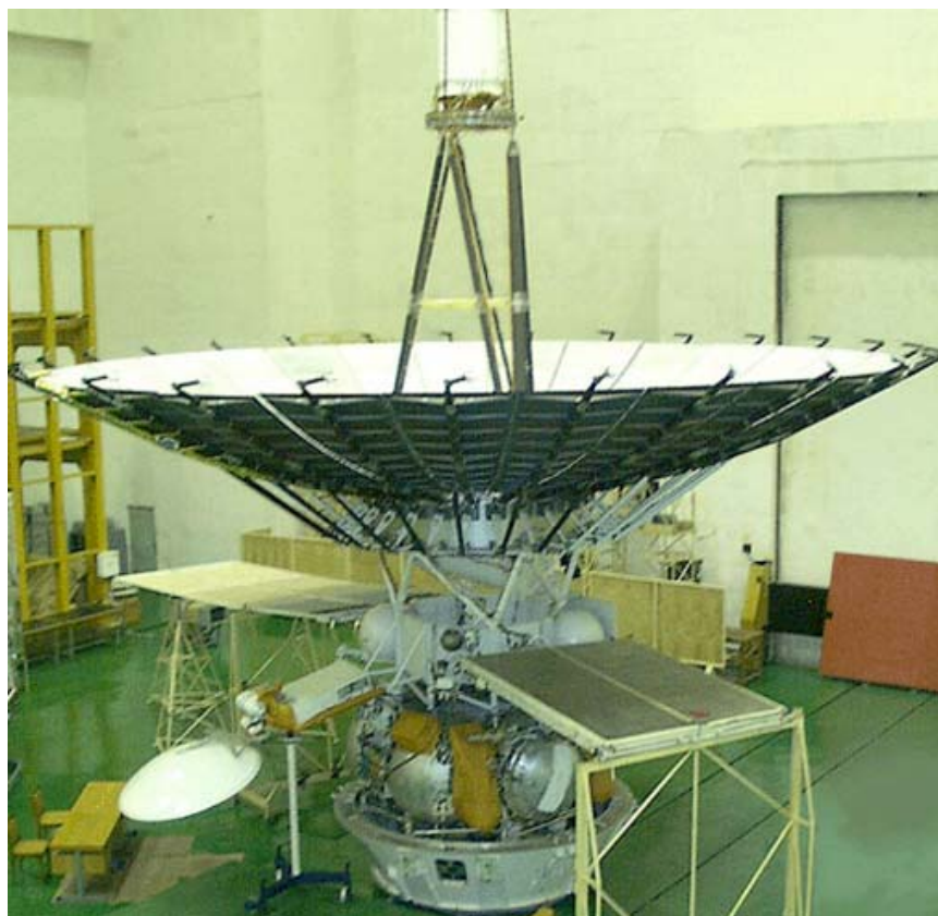
Рис.1. Вид КА «Спектр-Р» с КРТ в орбитальной конфигурации в сборочном цехе ФГУП НПО им.С.А.Лавочкина (также видны разгонный блок «Фрегат» и адаптер к ракете-носителю)
