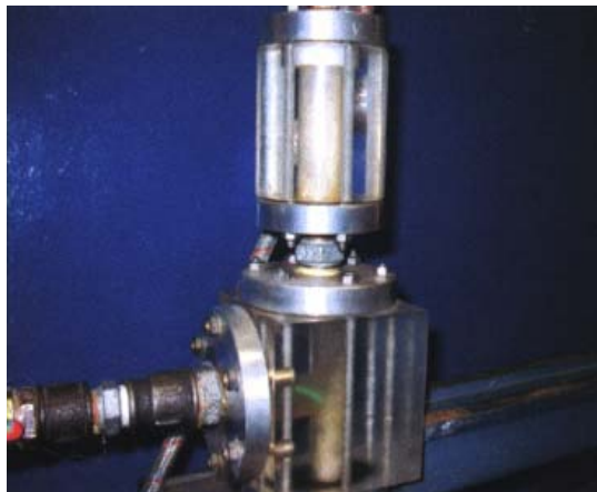
Рис.13. Барботажная камера (снизу) с прикрепленной к ней сверху ударноволновой ячейкой (вверху) в процессе работы.
