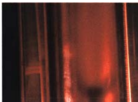
Рис. 15. Визуализация фронта ударной волны ( M = 2,2 ; \varphi_l = 0,84 ). Цилиндр d=5 мм, обтекается газожидкостным потоком.
