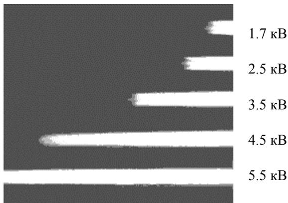
Рис.2. Вид свечения разряда под ПЭ при различных амплитудах импульсного потенциала.
