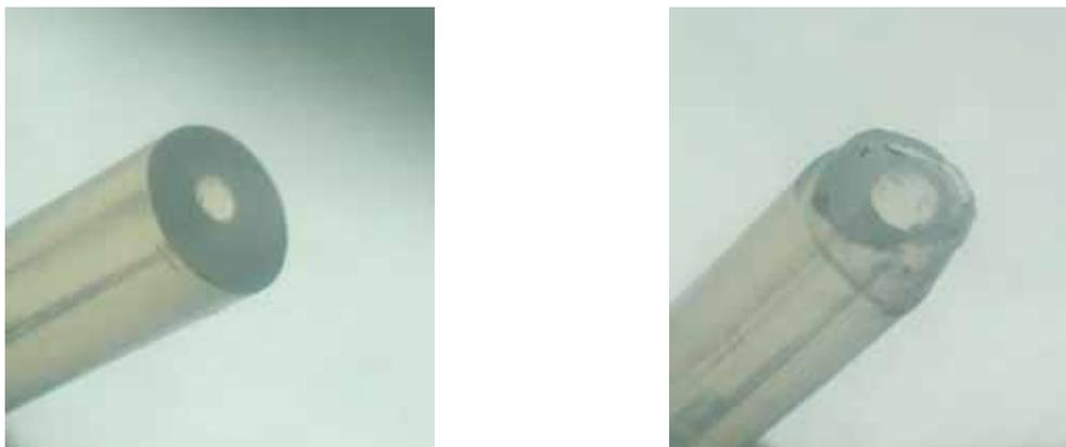
Рис. 4 а, б. Торец канала до начала эксперимента и через 30 мин.
