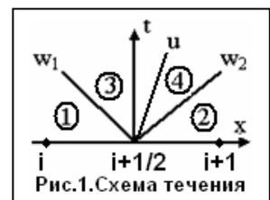
Обозначим индексами: 1- параметры в левой ячейке сетки, 2- в правой, 3- между левой волной и контактным разрывом, 4- между контактным разрывом и правой волной (рис.1). Решение задачи имеет вид:
