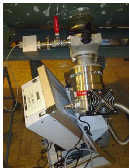
Рис.4. Откачной пост Иmvac SST551/DryII
