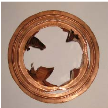
Рис.13. Медная мембрана после раскрытия
