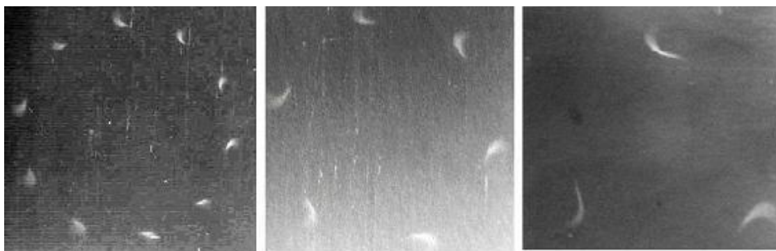
Рис.2. Фотографии пламен, вращающихся в радиальной кольцевой камере сгорания. Направление вращения – против часовой стрелки. Фотографии получены при горении богатой пропано-воздушной смеси с расходом \sim 0.1 л/сек.
