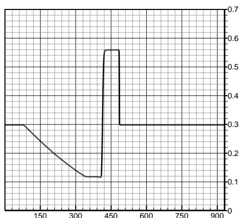
Рис. 2. Пространственное распределение температуры T в момент времени t = 3.4 мс после разрыва диафрагмы (без адаптации)
