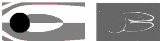
Рис. 5. Сравнение численного расчета (слева) и эксперимента (справа) при обтекании для числа Рейнольдса 28.4
