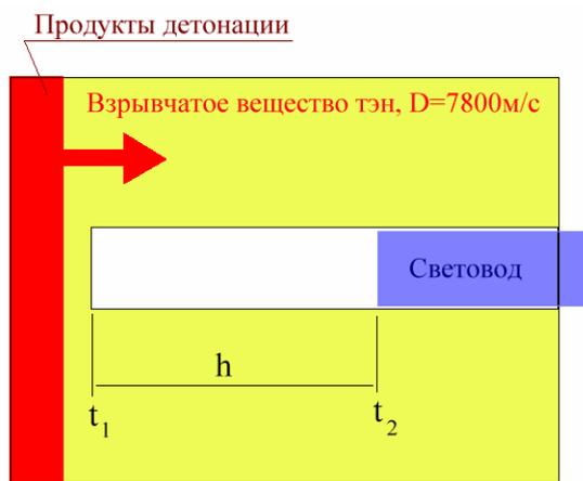
Рис.4. Схема эксперимента [3]
