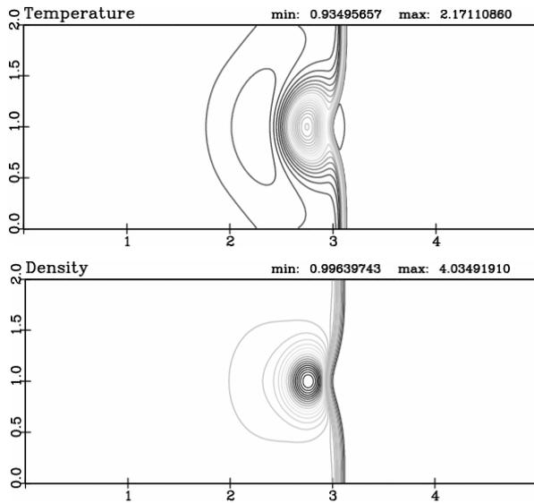
Рис. 2. Изолинии плотности и температуры при  $t=1.0$  для  $Kn=0.01$
