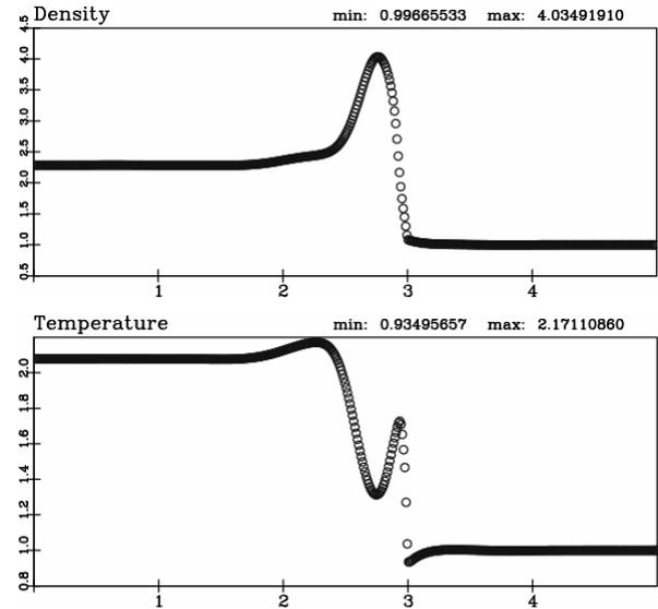
Рис. 3. Профили плотности и температуры вдоль линии  $y=1.0$  для  $Kn=0.01$
