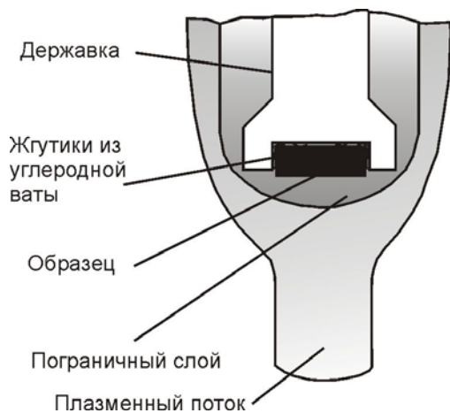
Рис. 1. Схема эксперимента по определению скорости уноса массы углеродных материалов.
