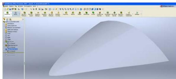
Предварительный вариант модели поверхности гиперзвукового аппарата Waverider
