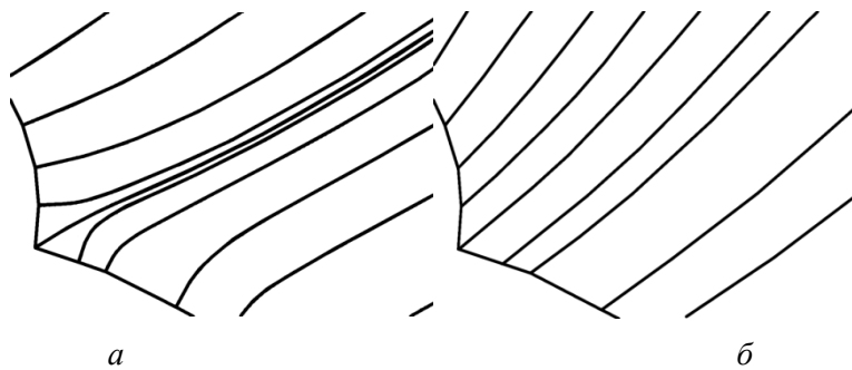
Рис. 1. Поведение силовых линий в угле: а) b=2 , б) b=1
