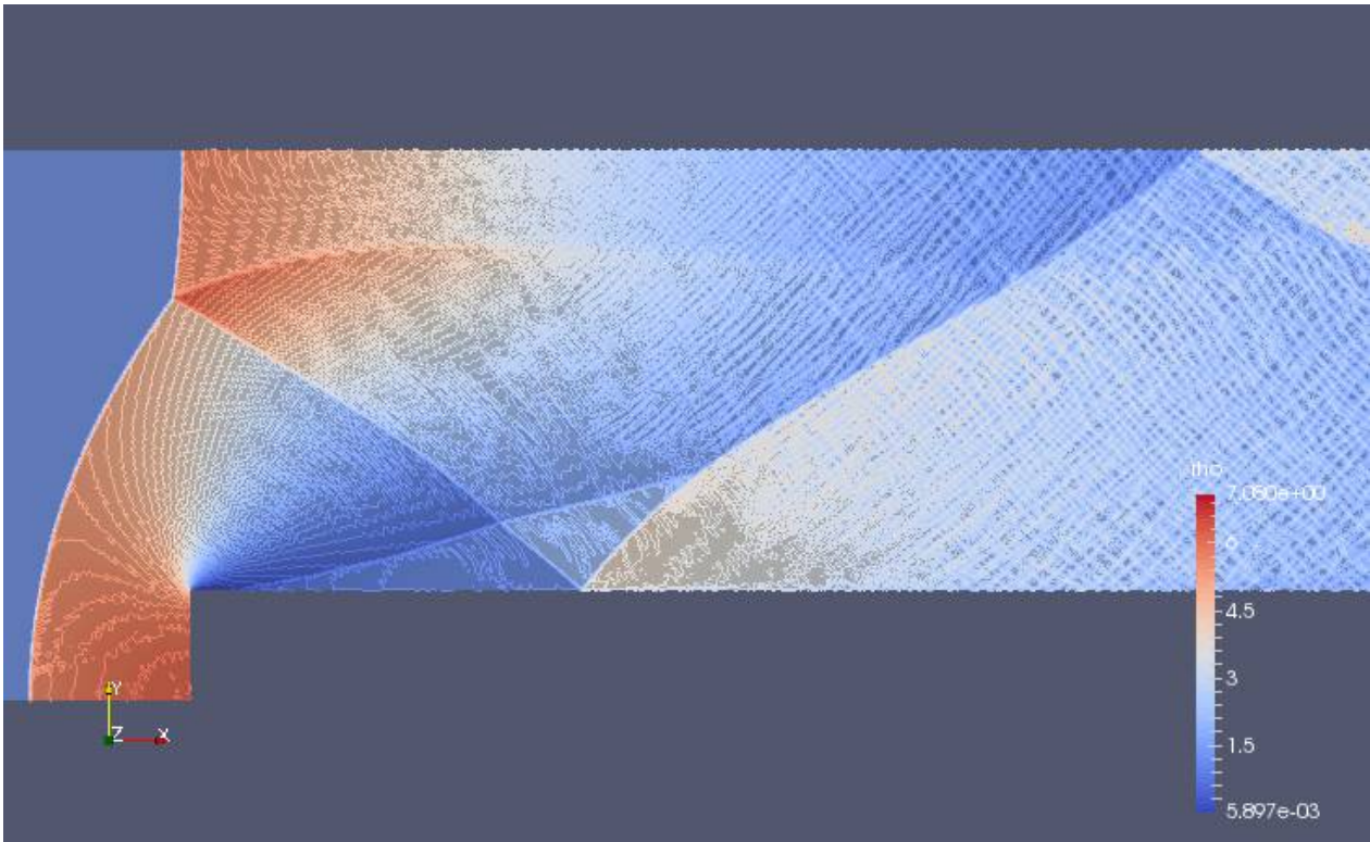
Рис. 5. Поле плотности, схема Roe с лимитером Ван-Лера, второй порядок, первый порядок по времени
